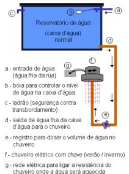
Sistema tradicional de aquecimento de água no chuveiro residencial
